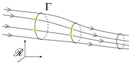
FIGURE 10 – Exemple de tube de champ
