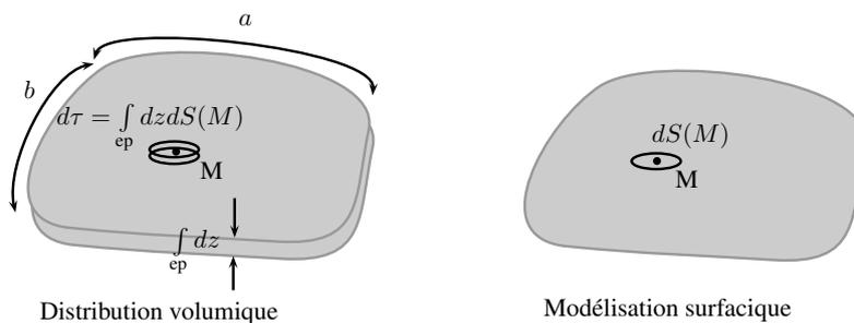
FIGURE 1 – Modélisation surfacique ;  $ep$  est l'épaisseur "locale" de l'objet.
