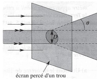
Il s'agit du phénomène de **diffraction** qui ne peut être interprété que dans le cadre d'un modèle ondulatoire : si le diamètre  $D$  diminue, alors l'angle  $\theta$  augmente. L'angle  $\theta$  prend des valeurs non négligeables lorsque  $D$  est de l'ordre de grandeur de la longueur d'onde  $\lambda$ . De manière générale, **le phénomène de diffraction se manifeste lorsque les caractéristiques des milieux traversés varient à l'échelle de la longueur d'onde.**
