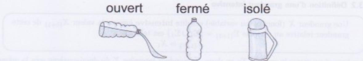
FIGURE 2 – Le contenu de la bouteille désigne dans chaque cas un système ouvert, fermé ou isolé.
