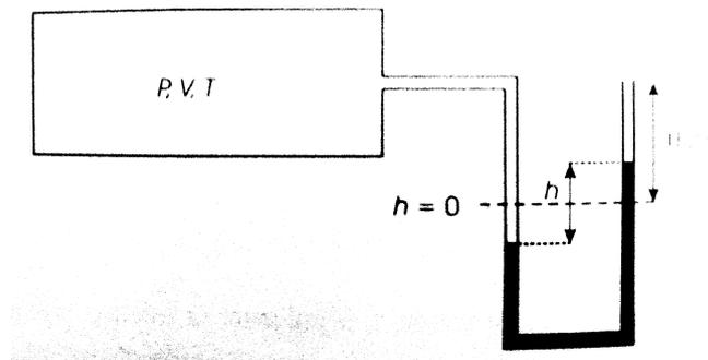
FIGURE 1 – Principe de fonctionnement d'un manomètre ou d'un thermomètre.
