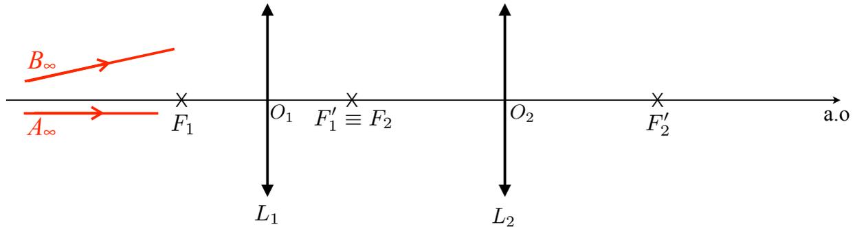
• **Position de l'image d'un objet à l'infini** : Le point objet à l'infini  $A_\infty$  dans la direction de l'axe  $\vec{u}_A$  a pour image à travers  $L_1$  le foyer principal image  $F_1'$  qui coïncide avec  $F_2$ . L'image définitive est donc celle de  $F_2$  à travers  $L_2$  donc le point image à l'infini  $A'_\infty$  dans la direction de l'axe  $\vec{u}'_A = \vec{u}_A$ .
