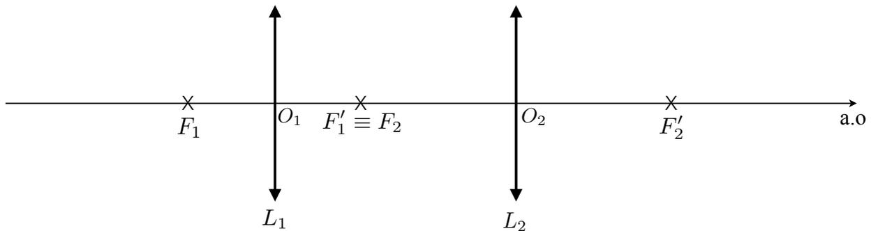
• **Cas convergente-divergente :** avec  $L_1$  convergente et  $L_2$  divergente,  $F'_1$  est à droite de  $O_1$  confondu avec  $F_2$  qui doit être à droite aussi de  $O_2$  par virtualité. Cela n'empêche pas  $O_2$  d'être à droite de  $O_1$ . D'après le théorème du retour inverse, on peut aussi disposer de doublet afocal commençant par une lentille divergente et finissant par une lentille convergente.
