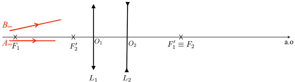
• **Position de l'image d'un objet à l'infini :** Le point objet à l'infini  $A_\infty$  dans la direction de l'axe  $\vec{u}_A$  a pour image à travers  $L_1$  le foyer principal image  $F'_1$  qui coïncide avec  $F_2$ . L'image définitive est donc celle de  $F_2$  à travers  $L_2$  donc le point image à l'infini  $A'_\infty$  dans la direction de l'axe  $\vec{u}'_A = \vec{u}_A$ .
