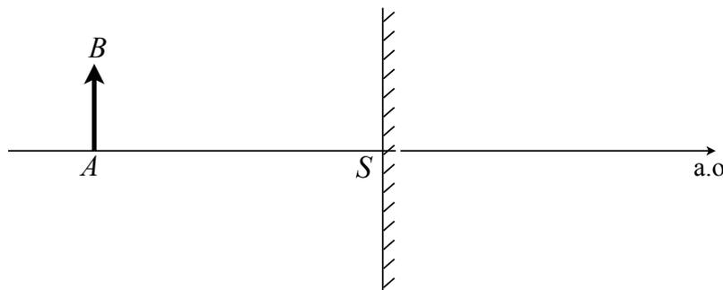
Ainsi, un objet réel (respectivement virtuel) donne une image virtuelle (respectivement réelle) droite de même taille après réflexion.
