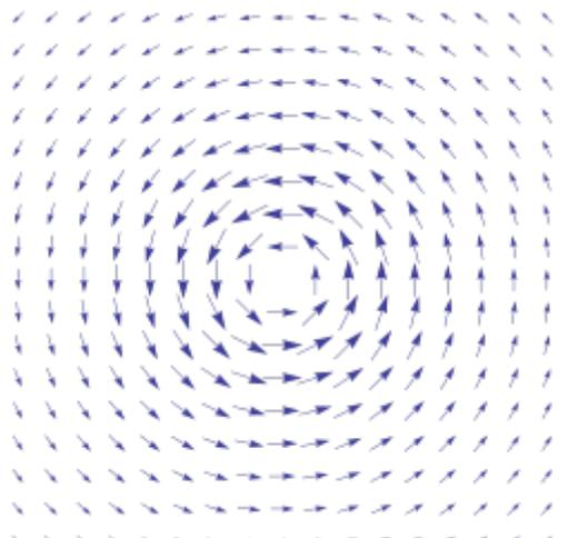
FIGURE 1 – Exemple d'un champ de vecteurs à rotationnel non nul
