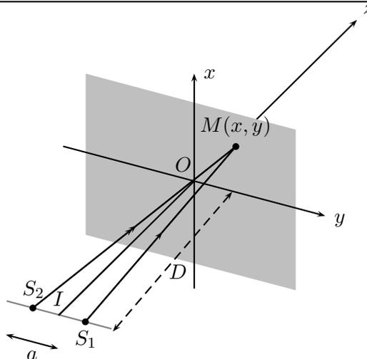
FIGURE 3 – L'écran est parallèle à  $(S_1S_2)$  : approximation des franges rectilignes
