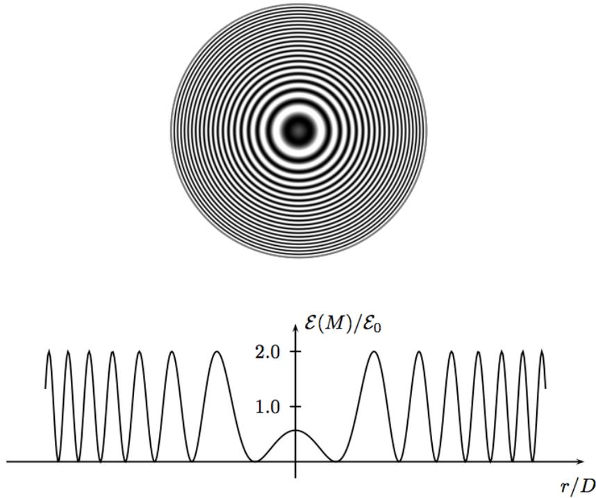
**FIGURE 6** – Allure de la figure d'interférences
