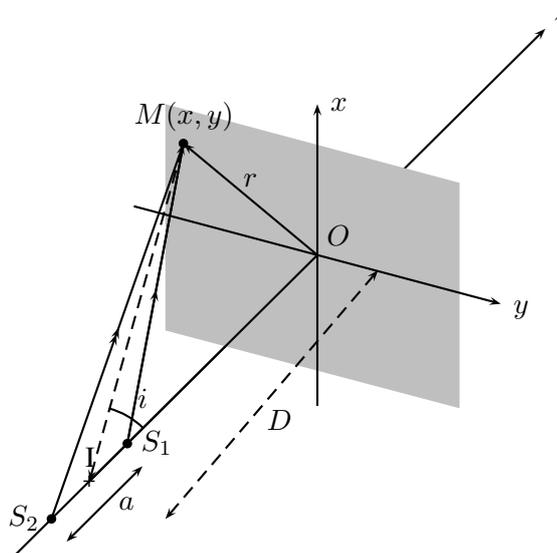
FIGURE 5 – L'écran est orthogonal à  $(S_1S_2)$  : franges circulaires
