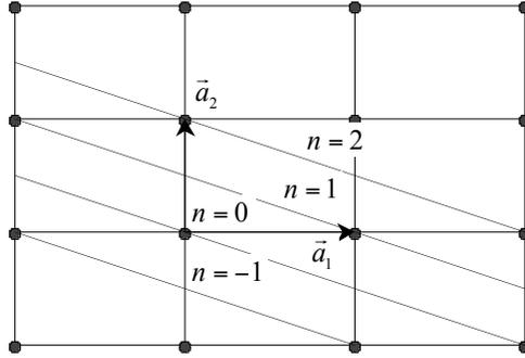
Figure 4 : Lignes réticulaires (1,2) dans le réseau rectangulaire simple
