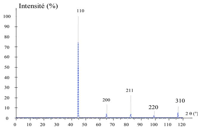
En utilisant la loi de Bragg on déduit le paramètre  $a = 2,87 \text{ \AA}$ .
