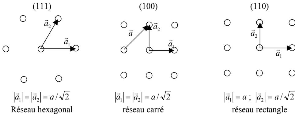
3. Les images de diffraction correspondantes auront respectivement l'allure des réseaux réciproques ci-dessous :
