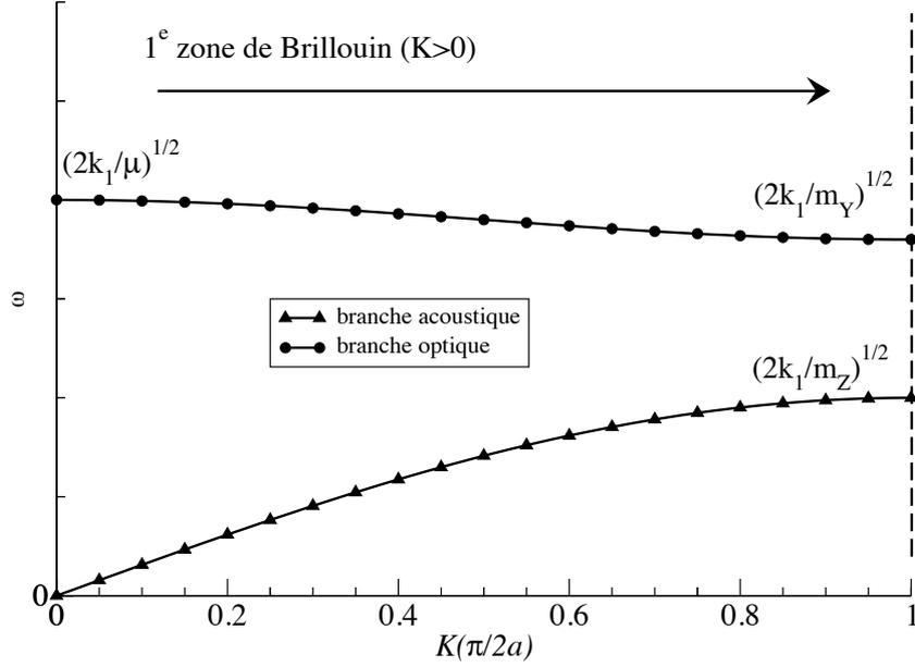
Figure 1: Représentation des branches acoustique et optique (pour  $k > 0$ ). Une bande interdite est observée entre la "bande" acoustique et la "bande" optique. Il faudra faire les identifications suivantes:  $k_1 = K$ ,  $m_Y = M_1$ ,  $m_Z = M_2$ ,  $K = k$ .
