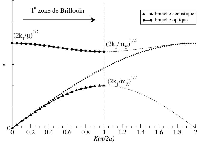
Figure 2: Représentation des branches acoustique et optique (pour  $k > 0$ ). Une bande interdite est observée. Ce gap en bord de zone se referme lorsque  $M_1$  et  $M_2 \rightarrow \frac{M_1+M_2}{2}$ . (Identifications:  $k_1 = K$ ,  $m_Y = M_1$ ,  $m_Z = M_2$ ,  $K = k$ )
