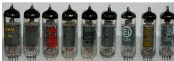
FIGURE 2.1.1 – Tube à vide de type EL84, fabriqués en Russie, et Slovaquie. (1er en 1906 par Lee De Forest) ( http://commons.wikimedia.org/wiki/File:EL84.JPG?uselang=fr ).
