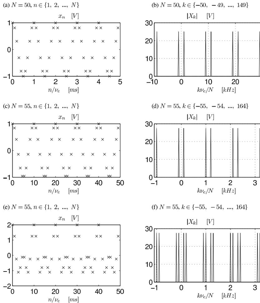
FIGURE 7 – Figure 1 : Échantillonnage et repliement spectral.
