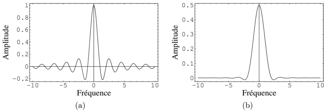
FIGURE 8 – Partie réelle de la transformée de Fourier des deux fenêtres  $w_1$  et  $w_2$ .
