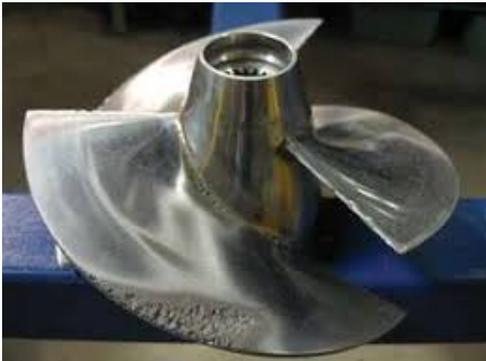
L'hélice de bateau est endommagée par la destruction de bulles qui apparaissent lors de la rotation.
