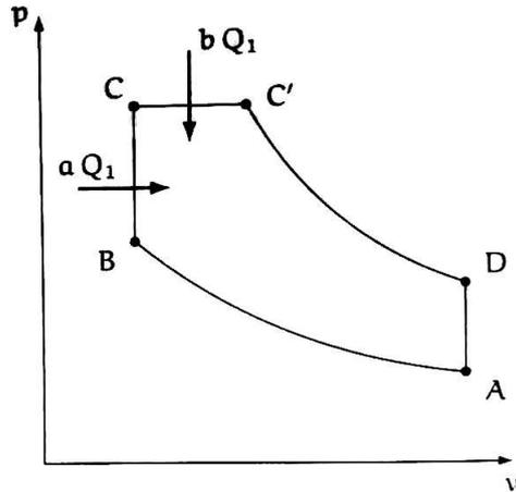
Suite au problème précédent, on considère un autre cycle moteur avec les mêmes contraintes techniques ( $\tau = 10$  et les températures extrêmes restent  $T_{max}$  et  $T_{atm}$ ), représenté dans la figure ci contre :
