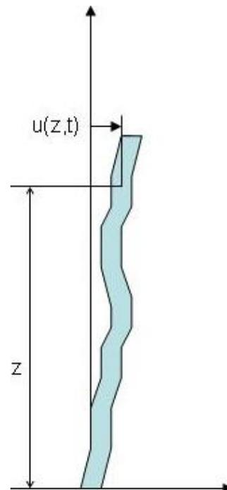
Fig3 : structure poutre équivalente
