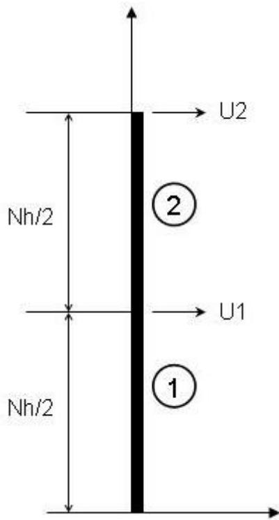
Fig4 : discrétisation éléments finis de la structure
