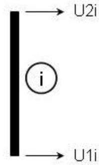
Fig5 : élément fini de poutre
