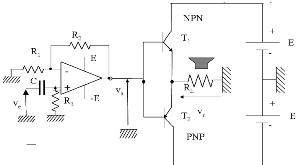
Figure 3: Circuit à base d'amplificateur de puissance de classe B.
