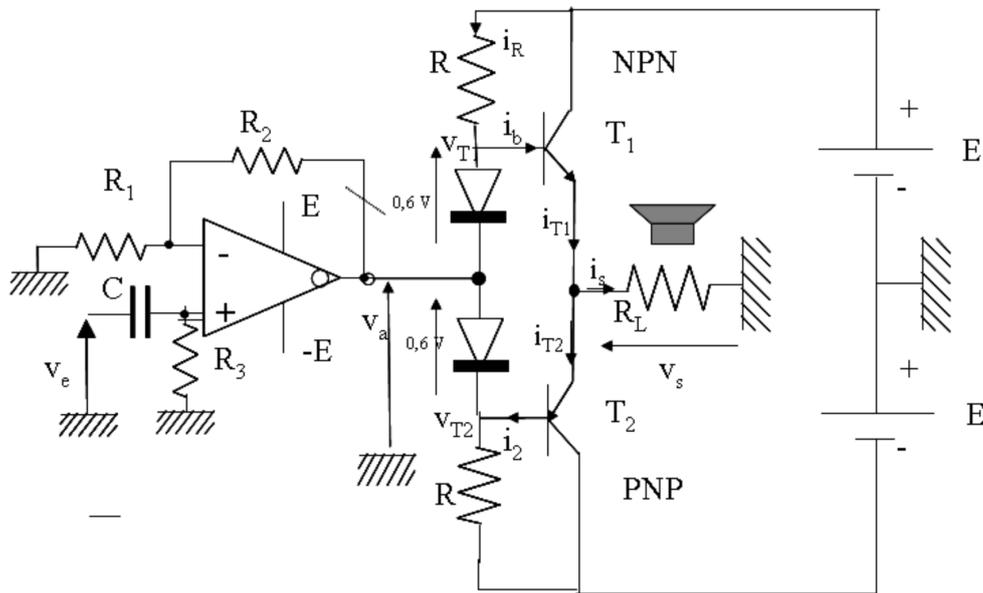
Figure 4: Circuit à base d'amplificateur de classe AB.
