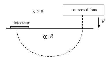
L'impact sur le détecteur permet de connaître le rayon R de la trajectoire et donc le rapport  $\frac{q}{m}$  connaissant la tension accélératrice U et la norme du champ magnétique. Ce système permet de séparer des ions en fonction de leur masse et de leur charge; si on connaît par ailleurs la charge des ions, on peut en déduire leur masse.
