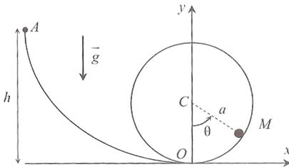
Un adepte du roller, assimilé à un point matériel  $M$  de masse  $m$ , se lâche sans vitesse initiale depuis le point  $A$  d'une rampe, situé à une hauteur  $h$  au dessus de  $O$ , point le plus bas de la rampe. À partir de  $O$ , la rampe a une forme cylindrique de rayon  $a$  : le patineur peut rouler à l'intérieur de ce cylindre en restant dans le plan vertical ( $xOy$ ), et éventuellement faire le tour complet. Le contact est sans frottement sur toutes les surfaces.
