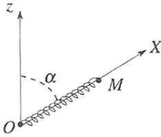
On considère une tige fixe, dans un plan vertical  $(xOz)$ , faisant l'angle  $\alpha$  avec l'axe vertical  $(Oz)$ . Un anneau  $M$  de masse  $m$  est enfilé sur la tige et astreint à se déplacer sans frottement le long de celle-ci. Cet anneau est également relié à un ressort de raideur  $k$  et de longueur à vide  $\ell_v$  dont l'autre extrémité est fixée en  $O$ . On repère la position de  $M$  par  $OM = X$  sur la tige inclinée.
