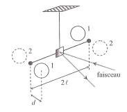
Pour chaque grosse sphère, on ne tiendra compte que de son action sur la petite sphère la plus proche. Lorsqu'on fait passer, par un dispositif opératoire non représenté ici, les deux grosses sphères de la position 1 à la position 2, le fléau tourne d'un angle  $2\theta_0$ . La mesure angulaire est réalisée par un miroir fixé sur le fléau et déviant un faisceau lumineux (méthode de Pogendorff).
