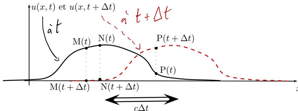
FIGURE 1 – Propagation d'une onde à la célérité  $c$
