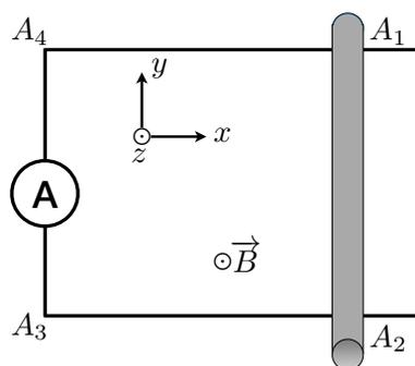
FIGURE 3 – Expérience des rails de LAPLACE
