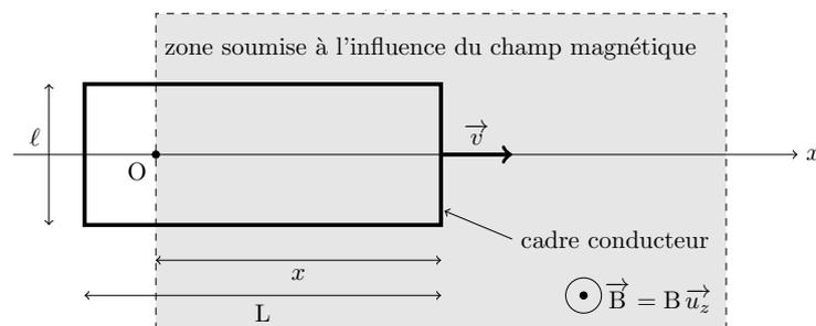
FIGURE 2 – cadre conducteur entrant dans la zone de freinage
