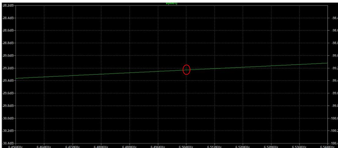
On peut voir que quand  $f=6.5\text{KHz}$ , l'amplitude est  $-29.233\text{dB}$ . Donc, on a :
