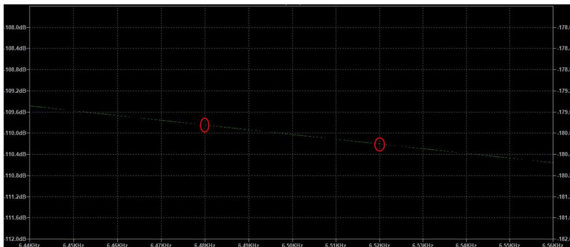
Quand  $f=6.48\text{KHz}$ , la phase est  $-179.839^\circ$  ; et quand  $f=6.52\text{KHz}$ , la phase est  $-180.202^\circ$  . Alors, on va calculer :
