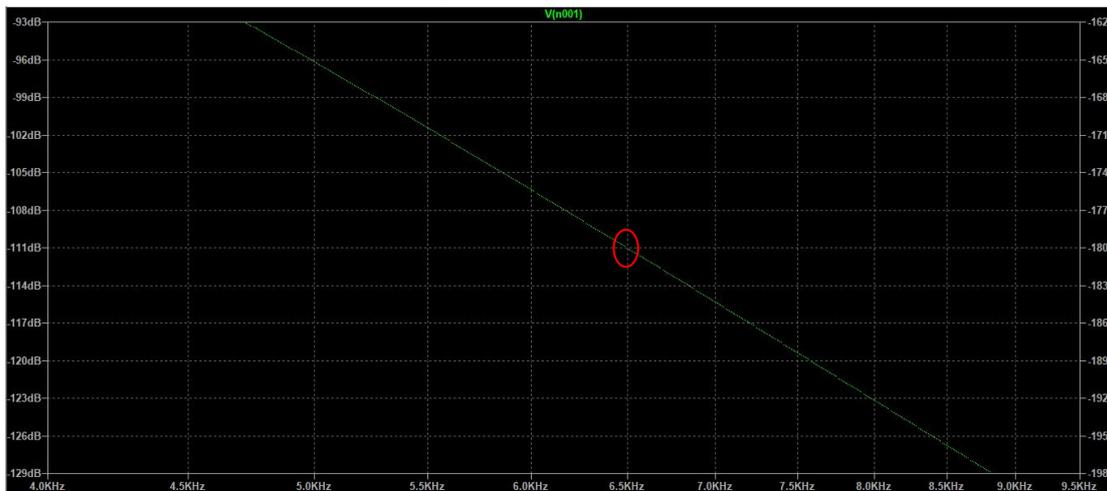
On sait que  $\varphi(\beta(j\omega_0)) = n * \pi$ . On peut voir que quand la phase égal à  $-\pi$ , la fréquence d'oscillation est  $f_0 = 6.5\text{KHz}$ .
