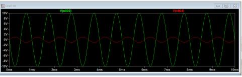
La ligne rouge représente la tension d'entrée, la ligne verte représente la tension de sortie.
