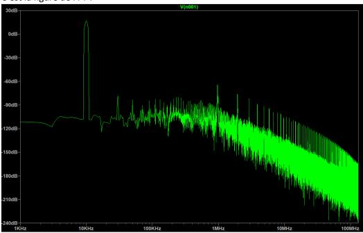
Alors on peut obtenir la différence de niveau en db entre le fondamental à 10 KHZ et l'harmonique de rang 3 à 30KHZ. C'est similaire avec le résultat à la fiche technique.
