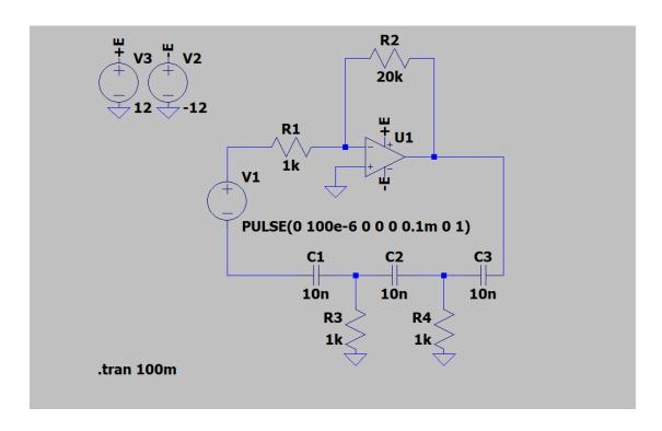
6. Quand  $R2 = 25k\Omega$ ,  $A\beta < 1$ : La sortie de ce circuit est :
