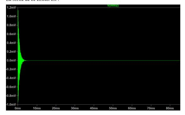
Quand R2 =  $30k\Omega$ ,  $A\beta > 1$ : La sortie de ce circuit est :
