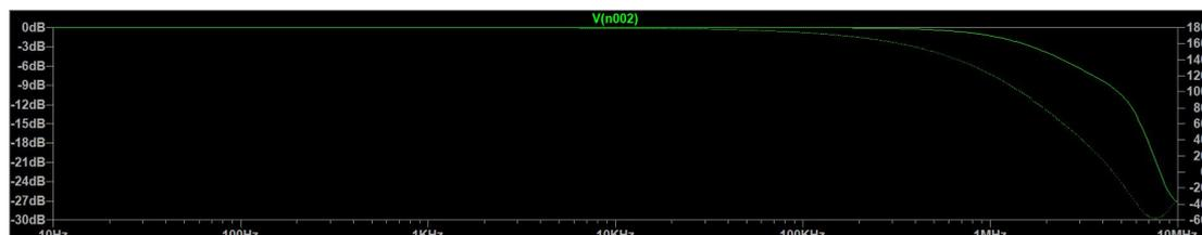
On peut trouver que la bande passante de  $-3\text{dB}$  est  $1.672 \text{ MHz}$ , et dans la fiche du constructeur, la bande passante correspond à  $-3\text{dB}$  est  $1.9\text{MHz}$ .
