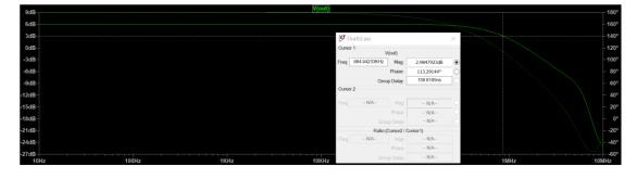
Et selon le figure, on sait que la bande passante a -3dB est 0.86MHz. Et 0.86 \* 2 = 1.72MHz presque égal a 1.68MHz, le produit gain-bande est constant.
