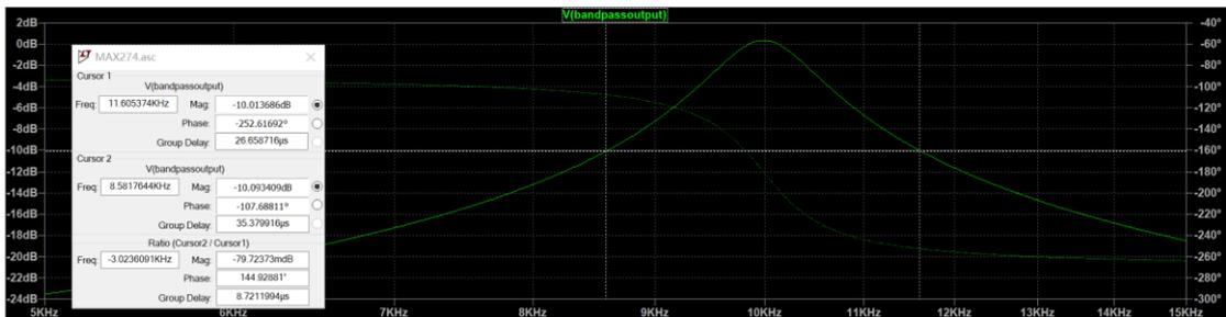
3. Pour un filtre avec la structure de 1 amplificateur opérationnel, on utilise les valeurs obtient par TD. Et on mesure V(bandpassoutput).
