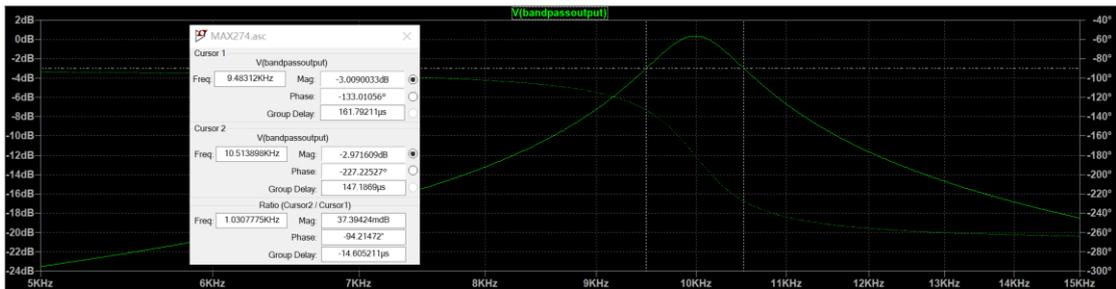
De la figure au-dessus, on peut voir que la bande passante de cet structure set 1kHz, et la fréquence centrale est 10kHz. Et de la figure au-dessous, on peut voir que la bande d'atténuation est presque 3kHz. Elle correspond au cahier des charges.
