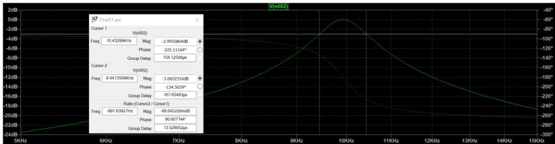
De la figure au-dessus, on peut voir que la bande passante de la structure est 1 kHz, et la fréquence centrale est 10 kHz. Et de la figure au-dessous, on peut voir que la bande d'atténuation est presque 3 kHz. Elle correspond au cahier des charges.
