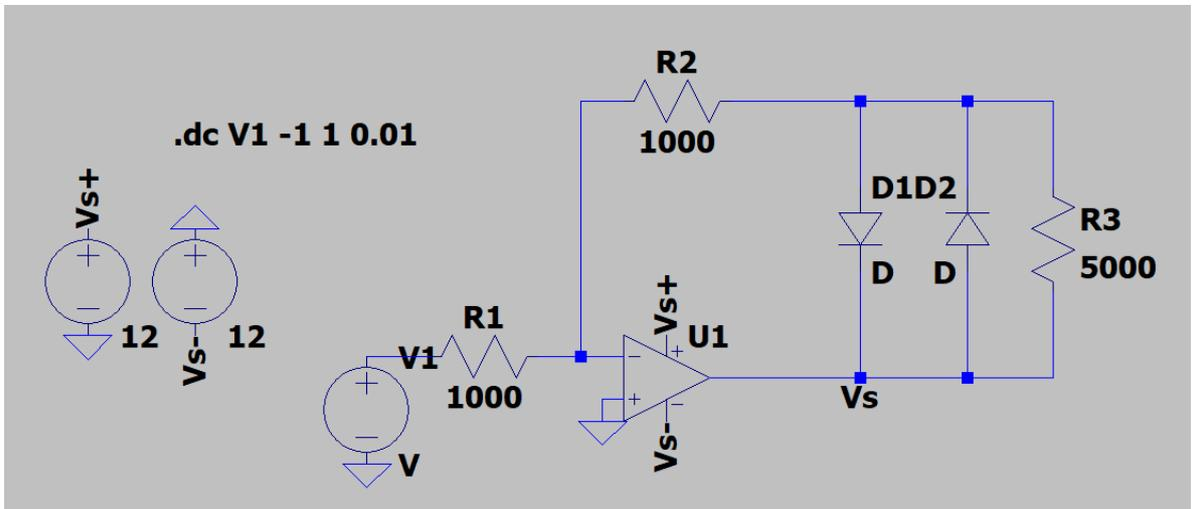
On choisie  $R_2 = 1000\Omega$  pour respecter la limite de l'amplificateur opérationnel.
