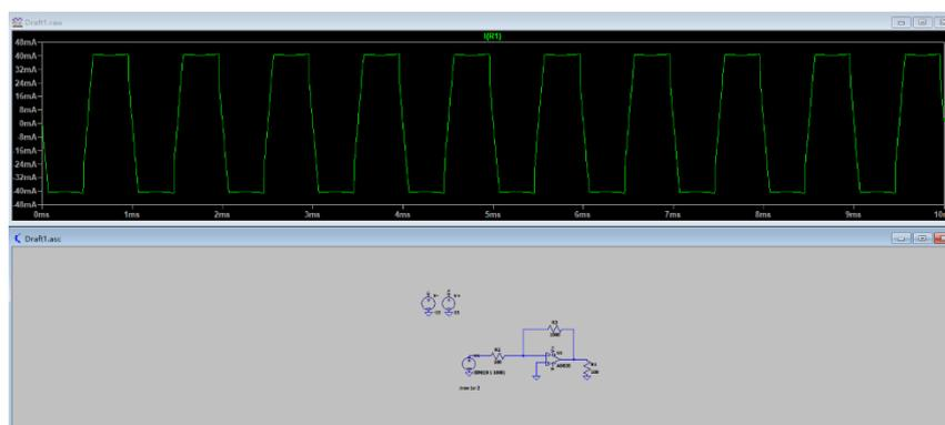
Je diminue la résistance de la charge, et j'observe une saturation du courant et c'est aussi une distorsion. Evidemment, le courant maximal de sortie est 40mA, ce qui correspond a la fiche technique.
