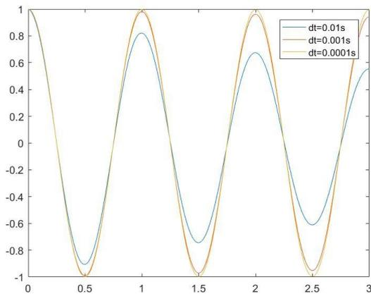
En testant différents pas de temps ( $\Delta t = 0.01s$ ,  $\Delta t = 0.001s$ ,  $\Delta t = 0.0001s$ ), on peut voir sur les résultats que plus le pas de temps  $\Delta t$  est petit, plus l'atténuation des oscillations est faible.
