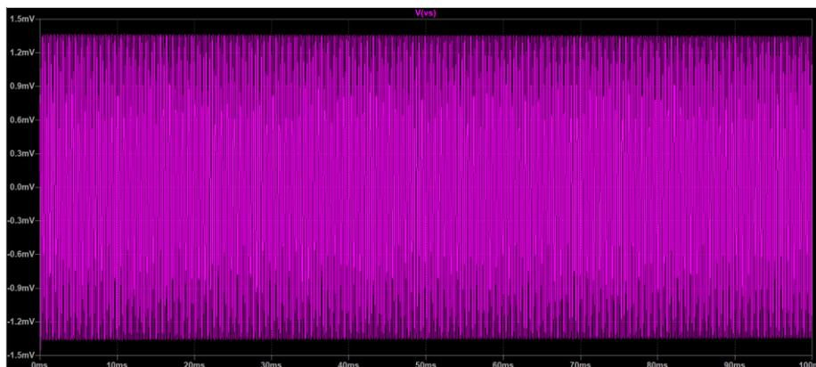
En plus, on mesure la fréquence de l'oscillation.  $f=1/T=1/(518.02871\mu\text{s}-365.90282\mu\text{s})=$
