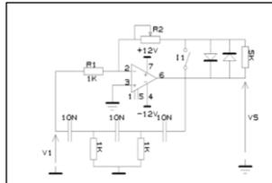
D'après la figure au dessus, on peut trouver  $A = -R2/R1$ , et on va calculer  $\beta(j\omega) = V_A/V_D$  ensuite.
