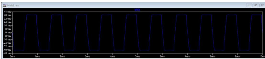
Quand  $R_3 = 50\Omega$ , le courant maximal de sortie est environ 43mA.
