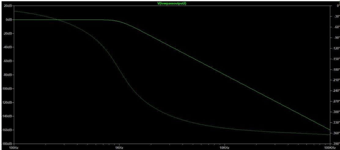
Quand  $f = 1\text{kHz}$ , il est environ  $-3\text{dB}$ . Quand  $f = 4\text{kHz}$ , il est environ  $-45\text{dB}$ .
