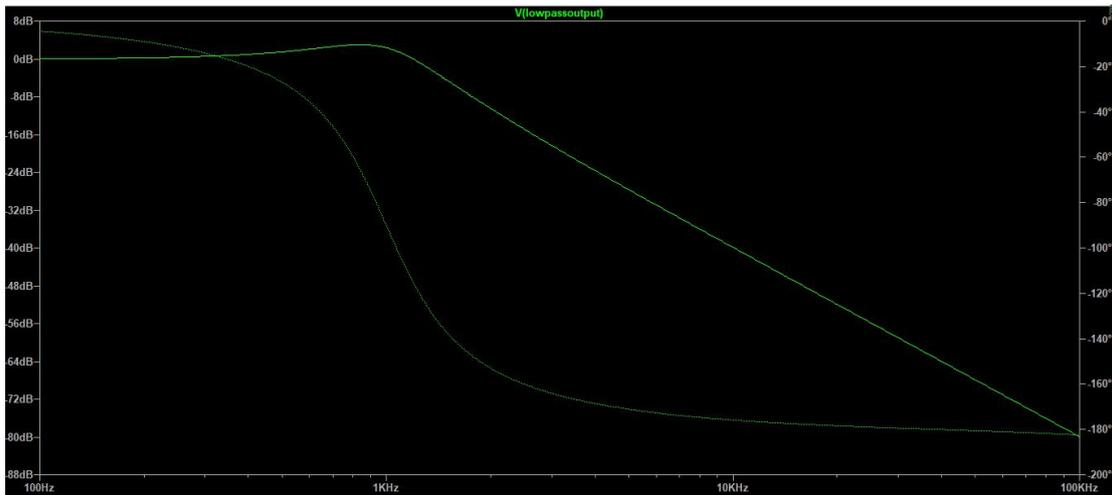
Quand  $f = 1\text{kHz}$ , il est environ 3dB, le plus grand. Quand  $f = 4\text{kHz}$ , il est environ -40dB.
