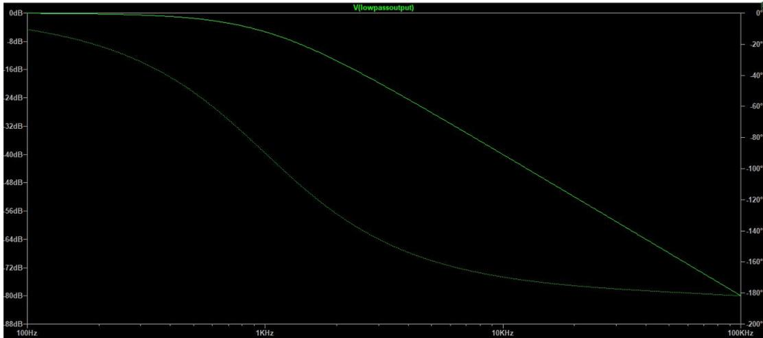
Quand  $f = 1\text{kHz}$ , il est environ  $-3\text{dB}$ . Quand  $f = 4\text{kHz}$ , il est environ  $-40\text{dB}$ .
