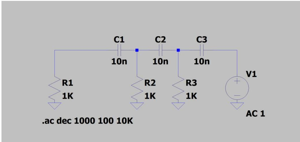
On obtient le résultat de la tension après avoir appliqué le schema:
