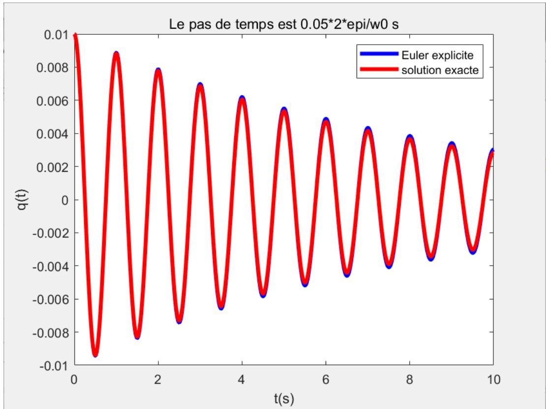
On peut voir que  $\Delta t \approx 0.00032s$ , la solution de EULER explicite converge vers la solution exacte. Donc, quand  $\frac{\Delta t}{\frac{2\varepsilon}{\omega_0}} < 0.05$ , la solution calculée présente-t-elle une précision suffisant.
