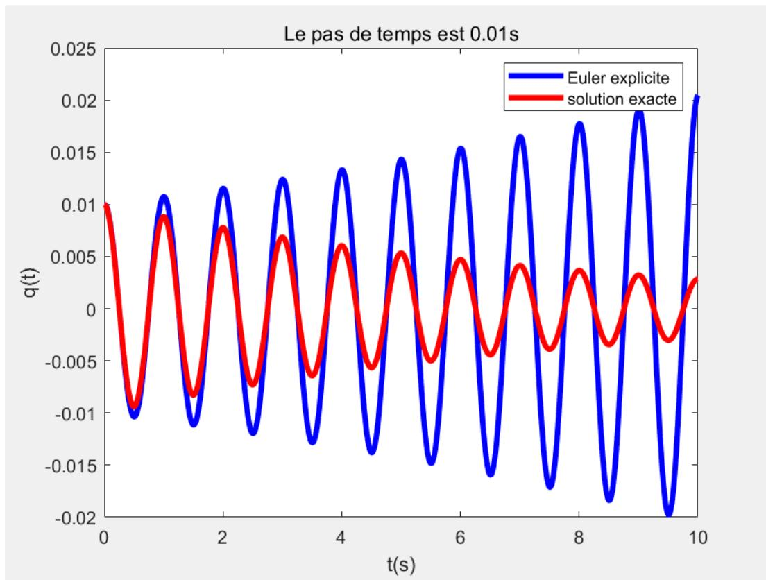
Donc, la solution numérique obtenue avec ce schéma d'intégration est divergente. Au début, Le résultat d'Euler explicite coïncide avec la solution exacte.
