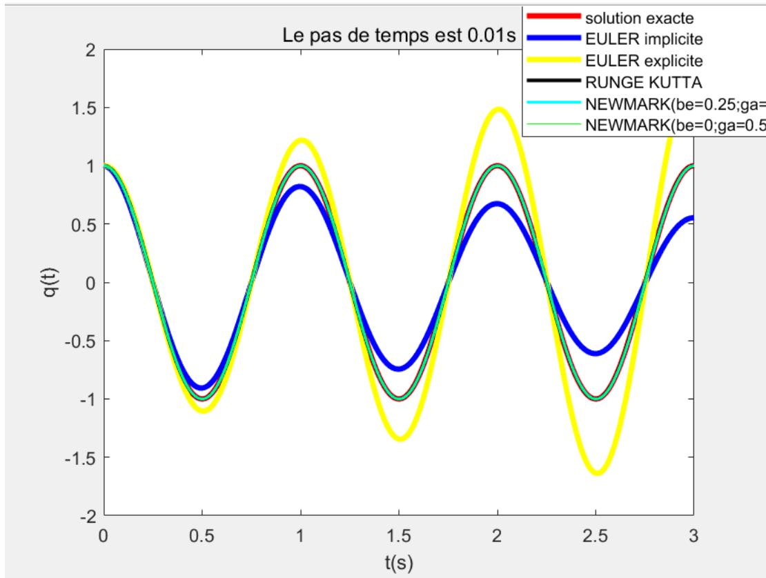
On peut voir que lorsque le pas de temps est de 0,01 s, le résultat de Runge Kuta et le résultat de NEWMARK est plus proche de la solution exacte que l'Euler explicite et l'Euler implicite (pour mieux afficher les résultats, on choisit que ‘LineWidth’ de la valeur exacte est 3 et ‘LineWidth’ de Runge Kuta est 2, ‘LineWidth’ de NEWMARK( $be=0.25;ga=0.5$ ) est 1.5, ‘LineWidth’ de NEWMARK( $be=0;ga=0.5$ ) est 0.5).
