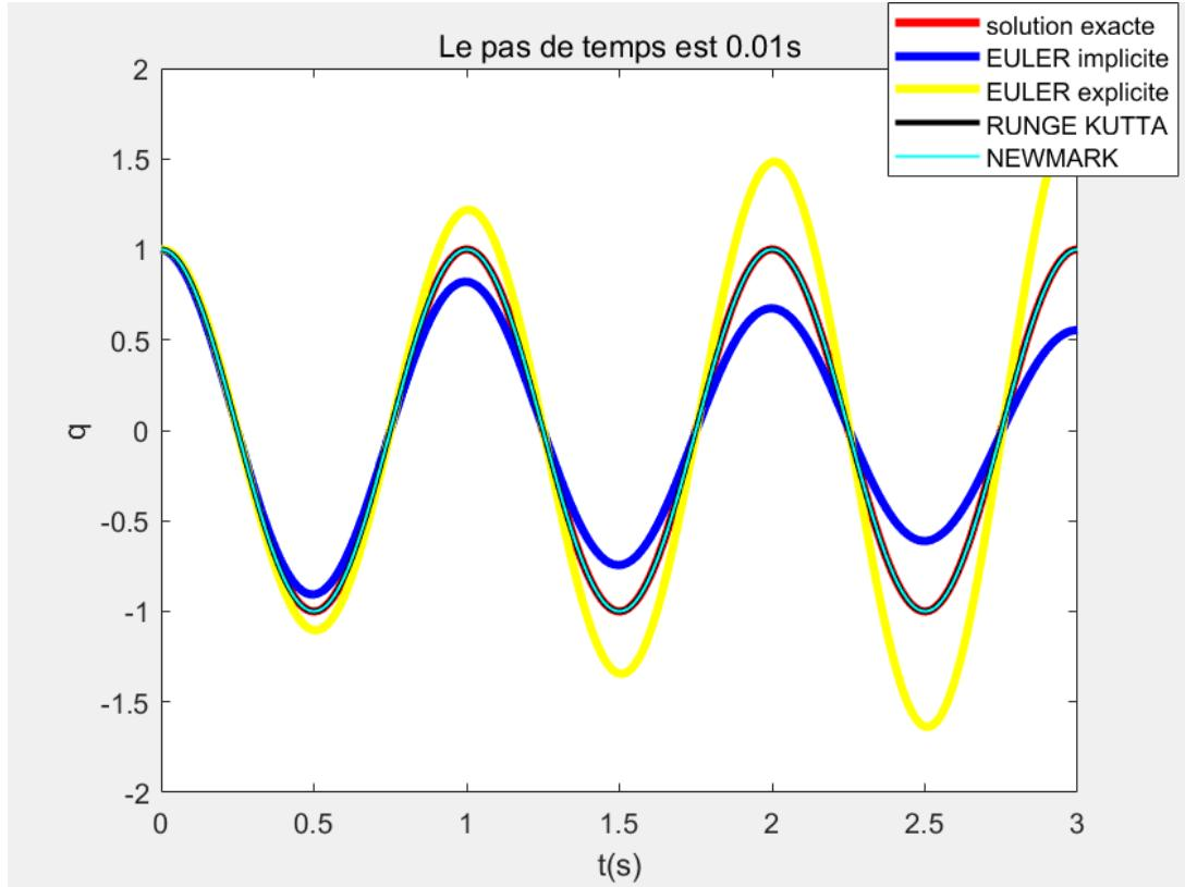
On peut voir que lorsque le pas de temps est de 0,01 s, le résultat de Runge Kuta et le résultat de NEWMARK est plus proche de la solution exacte que l'Euler explicite et l'Euler implicite (pour mieux afficher les résultats, on choisit que 'LineWidth' de la valeur exacte est 3 et 'LineWidth' de Runge Kuta est 2, 'LineWidth' de NEWMARK est 1).
