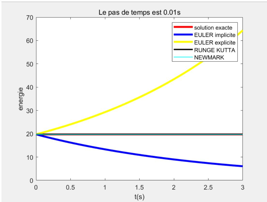
On peut voir que lorsque le pas de temps est de 0,01 s, le résultat de Runge Kuta et le résultat de NEWMARK est plus proche de la solution exacte que l'Euler explicite et l'Euler implicite (pour mieux afficher les résultats, on choisit que 'LineWidth' de la valeur exacte est 3 et 'LineWidth' de Runge Kuta est 2, 'LineWidth' de NEWMARK est 1). Le résultat de NEWMARK change moins que celui de RUNGE KUTTA. (Runge Kuta :
