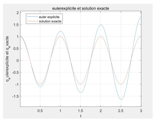
On voit que entre la solution exacte et la solution obtenueen utilisant Euler explicite, il y a un petit différence qui devient de plus en plus grand quand le temps augmente.
