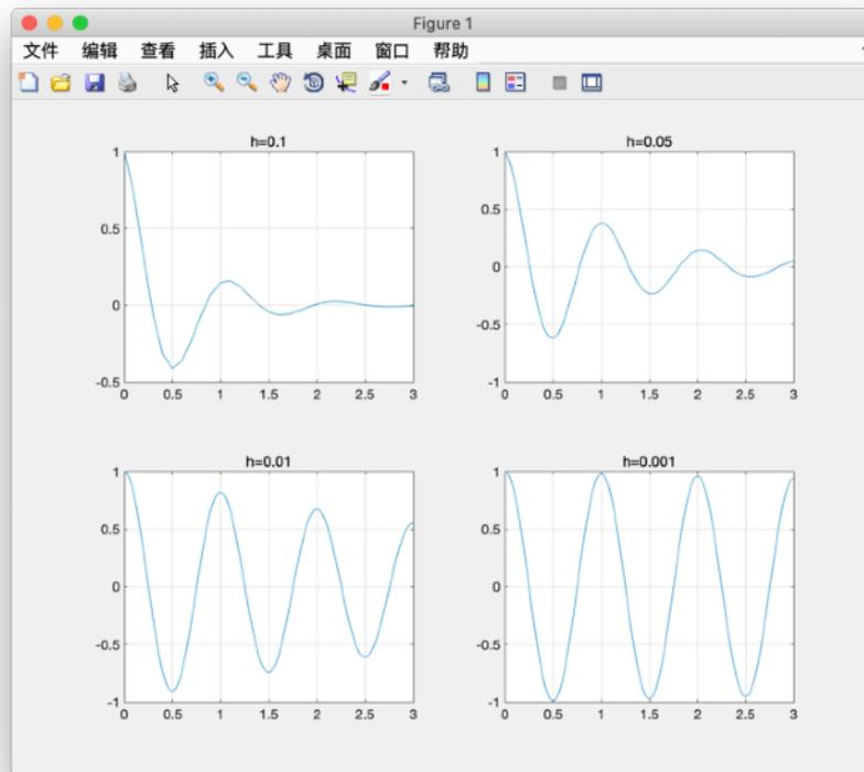
Dans ce graphique, on peut voir que le schéma introduit un amortissement numérique. Cependant, on peut trouver facilement que plus le pas de temps  $h$  est petit, plus l'atténuation des oscillations est faible.
