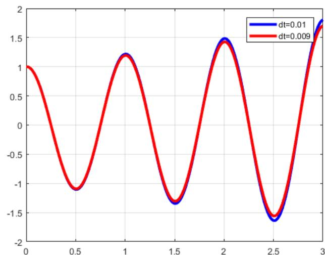
2.4 La quantité  $E^*$  associée au schéma d'EULER explicite est plus grand que les valeurs obtenues avec celles calculées à partir de la solution exacte. Et plus le pas de temps est petit, plus la quantité  $E^*$  est augmente lentement.
