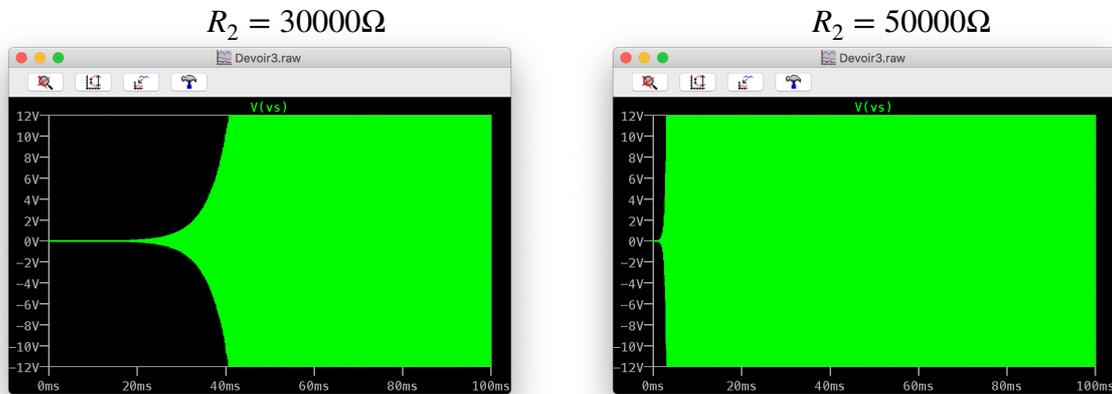
On peut voir que quand  $A\beta(j\omega) > 1$ , L'amplitude du signal de sortie  $V_s$  augmente alors très rapidement jusqu'à entraîner la saturation de l'amplificateur.
