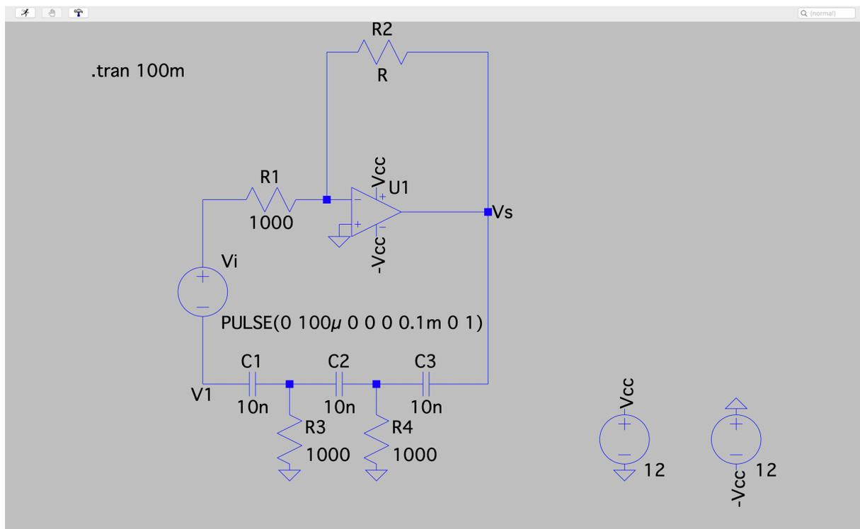
**Simuler temporellement le circuit et observer les trois régimes de fonctionnement en changeant la valeur de  $R_2$ . On utilisera pour cela une simulation de type « transient » sur une durée de 100 ms. Attention: le gain numérique peut être légèrement différent du gain théorique. Vérifier également que l'oscillateur oscille à la bonne fréquence**
