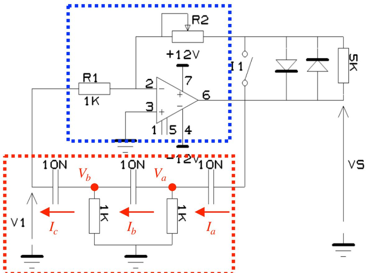
La partie bleue est l'amplificateur ( $A$ ) avec  $V_1$  comme l'entrée et  $V_s$  comme la sortie. La partie rouge est la réaction ( $\beta$ ) avec  $V_s$  comme l'entrée et  $V_1$  comme la sortie. On calcule alors les fonctions de transfert.
