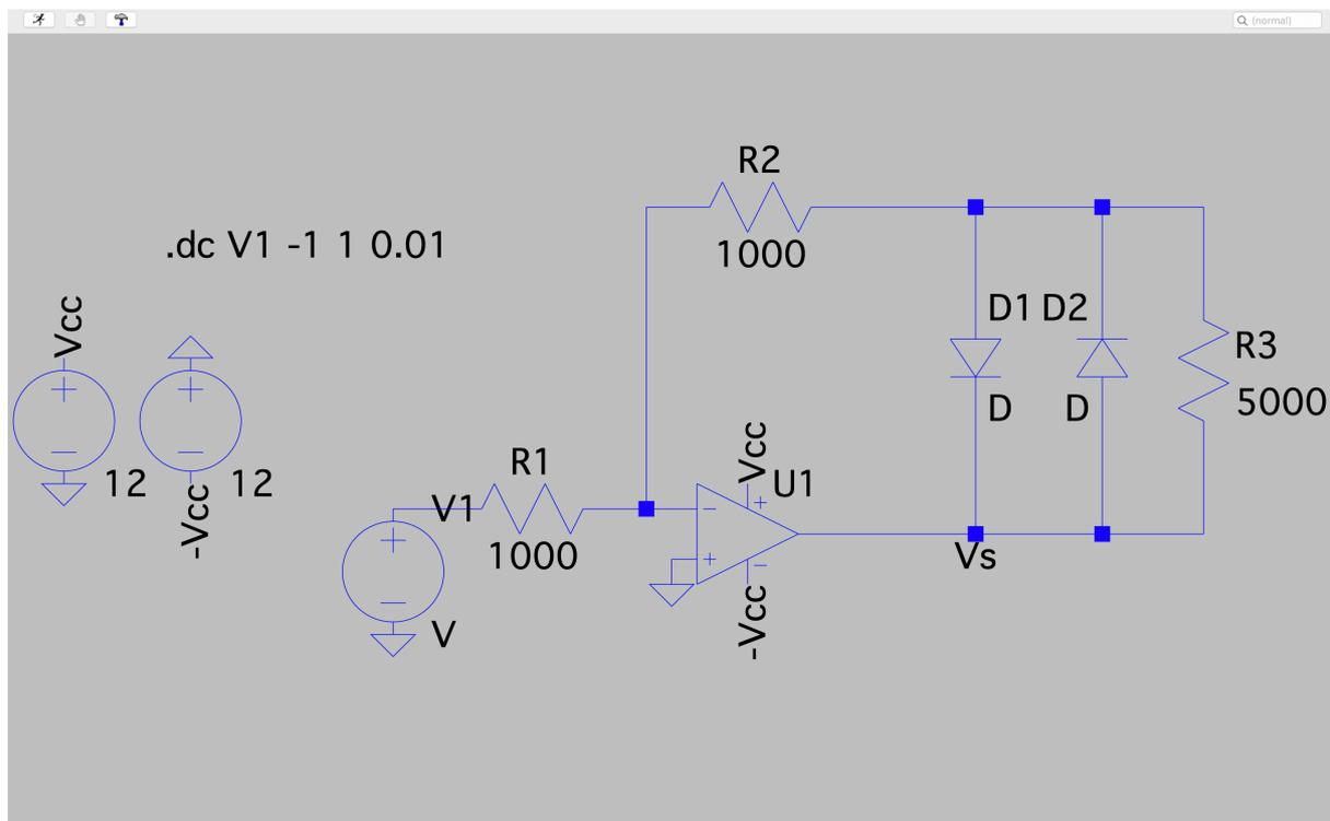
**En utilisant une simulation de type « DC sweep », simuler la caractéristique  $V_s = f(V_e)$  pour des tensions  $V_e$  comprises entre  $-1V$  et  $1V$ , et observer la non-linéarité du gain introduite par les diodes**
