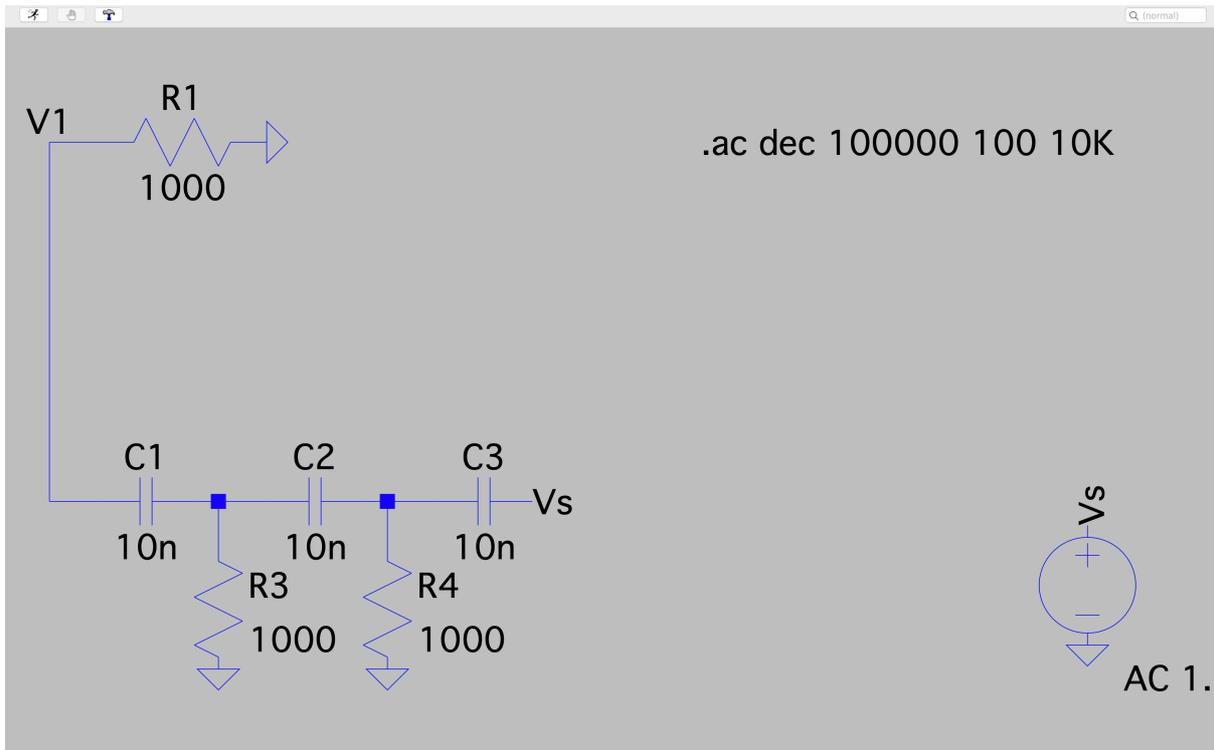
On fait la simulation et on observe la réponse fréquentielle de  $V_1/V_s$ . Le résultat est montré ci-dessous.
