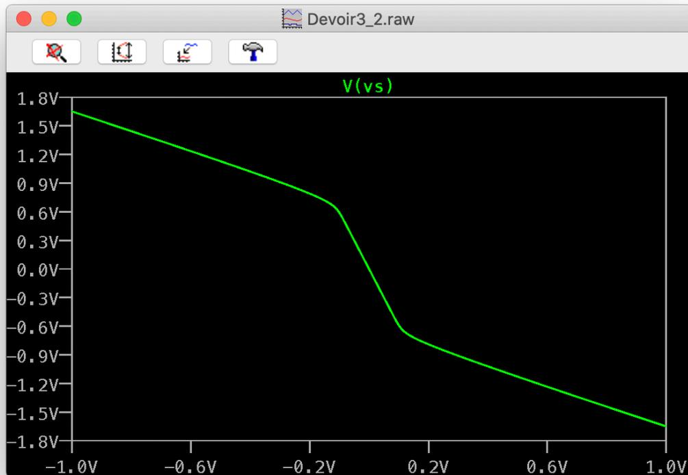
On peut donc voir la non-linéarité du gain. Pour les faibles tensions d'entrée, le gain est plus élevé. Pour les hautes tensions d'entrée, le gain est plus faible. Il est alors plus facile d'obtenir la condition d'oscillation.
