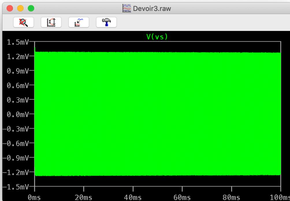
On peut voir que quand  $A\beta(j\omega) = 1$ , le signal de sortie  $V_s$  est oscillant et sinusoïdal. On obtient alors un oscillateur permanent. Pour vérifier la fréquence d'oscillation, on fait une transformation de Fourier du signal de sortie.
