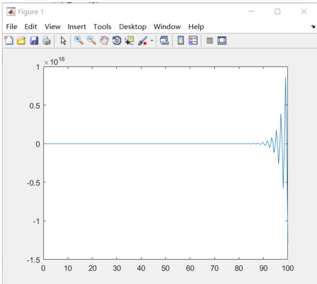
1.  $h$  doit être égal ou inférieur à 1 pour être précis et stable.
